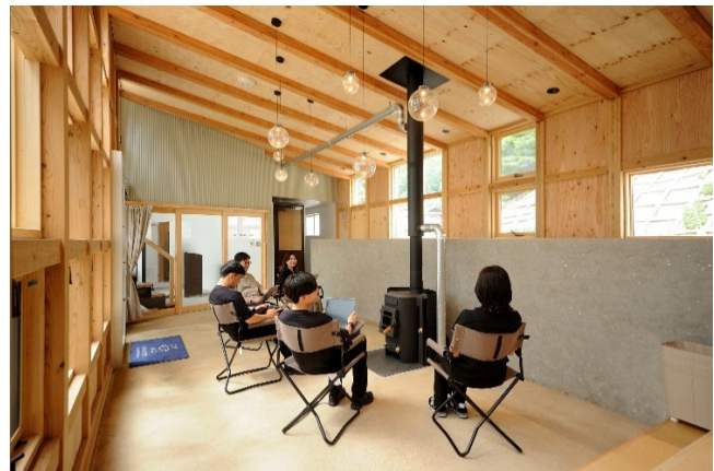
自然採光や薪ストーブの熱を利用した空気循環等、環境行動を促進する仕組みが随所に施されている
