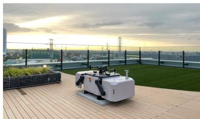
ドローンの離発着場。太陽光パネル点検や災害時物資配送の際に活用できるポートを屋上に 2ヶ所設置。また、敷地内の駐車場では利用者が持参したドローンポートを設置し、実験することも可能。
